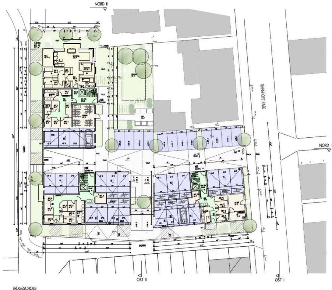
Es ist der Neubau von 3 Mehrfamilienhäuser geplant. Da sich das Bauvorhaben in der Gefährdungslage durch das 100-jährliche Hochwasser befindet, besitzen die Gebäude keine Keller oder Tiefgaragen. Die geplante Erdgeschossfußbodenhöhe liegt bei allen Gebäuden auf 224,42 mÜNN. Es ist geplant die Außenanlagen tiefer auszubilden, um den Retentionsraumverlust auszugleichen. Dies gilt für die Grünfläche im Nordosten und die Stellplätze.
