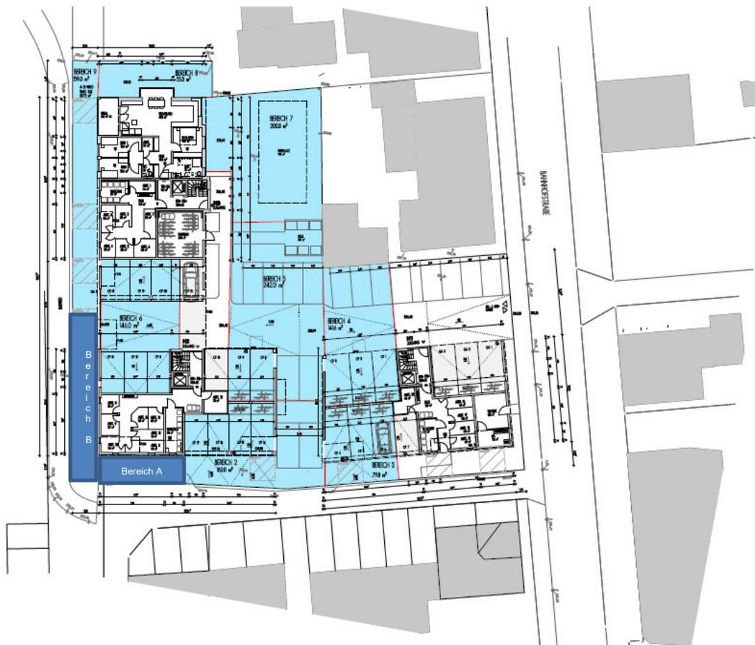
Der Retentionsraumausgleich erfolgt durch eine Abgrabung auf dem Baugrundstück. Hierbei wird empfohlen den Bereich A (rund 20 m<sup>2</sup>) und den Bereich B (rund 40 m<sup>2</sup>) gegenüber der bisherigen Planung abzusenken.
